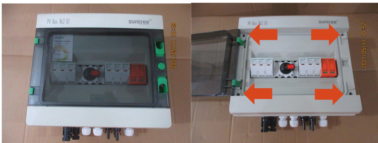
Рисунок 5.8 – Разбор корпуса PVBox.
